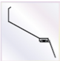
8 Stück a 4500 mm Wandanschlußprofil mit Aufkantung zum Versiegeln und Lippendichtung
