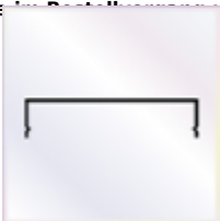
8 Stück a 4500 mm Wandanschlußprofil mit Aufkantung zum Versiegeln und Lippendichtung
