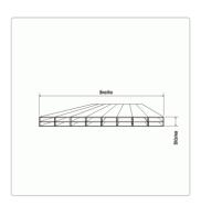
Stegplatten aus Polycarbonat in 6 mm Stärke Ausführung: tranparent - klar
