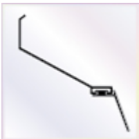
4 Stück a 2500 mm Wandanschlußprofil mit Aufkantung zum Versiegeln und Lippendichtung
