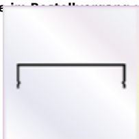
Wandanschlußprofil mit Aufkantung zum Versiegeln und Lippendichtung
