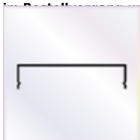
Wandanschlußprofil mit Aufkantung zum Versiegeln und Lippendichtung
